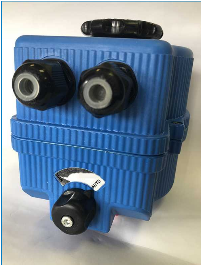
Stellung des Spülventilantriebs "AUTO"
