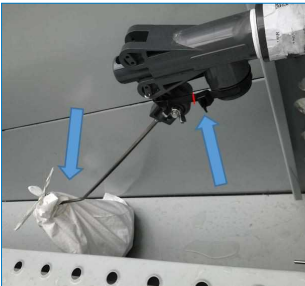
Befestigung und Umhüllung der Schwimmerkugel
