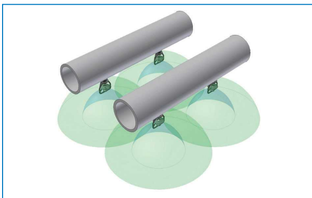
Kühlturm mit geschlossenem Kreislauf des Düsen-sprühverteilungstyps
