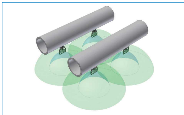
Tipo distribuzione spruzzi dagli ugelli per condensatore
