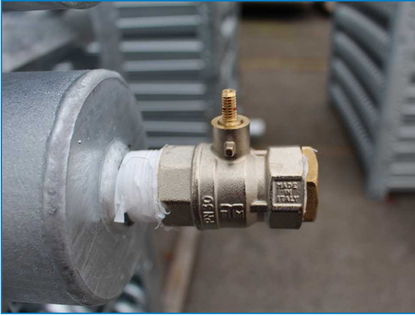
Raccord de batterie supérieure avec vanne de détente sur les tours de refroidissement à circuit fermé avec raccords supérieurs à DN 100.
