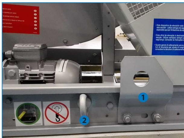
1. Œillet de levage : utilisez-le pour soulever l'appareil (manutention). Ne l'utilisez pas pour le fixer.
