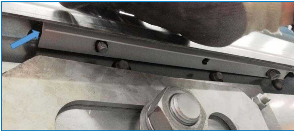
Un profil d'étanchéité installé
