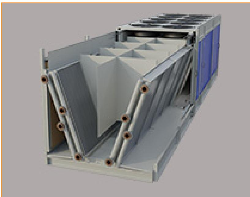
El equipamiento de una unidad con paneles de separación ofrece un **conducto de aspiración de aire individual para todos y cada uno de los ventiladores** en el enfriador adiabático. Esto garantiza una mayor capacidad en caso de avería del ventilador evitando que caudales de aire no previstos a través de un ventilador inactivo que elude la batería de enfriamiento.
