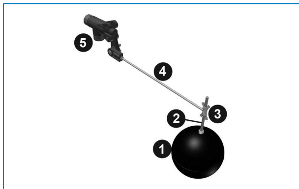
Узел клапана подпитки водой
