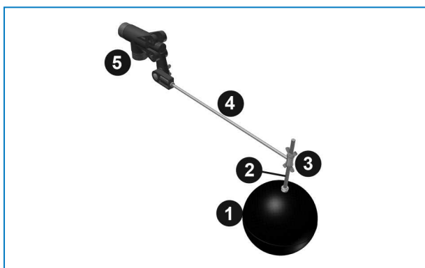
Sestava doplňovacího ventilu přídavné vody
